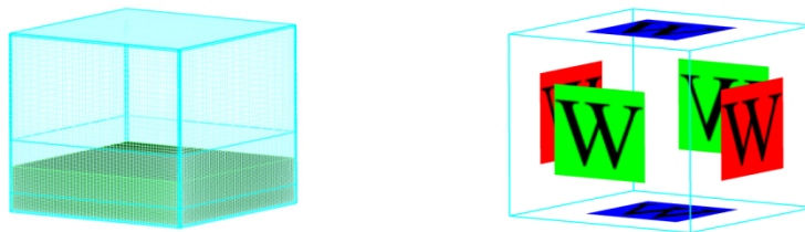
شکل ۳- شرایط مرزی و شبکه بندی مورد استفاده در مدل سازی مخزن مستطیلی
